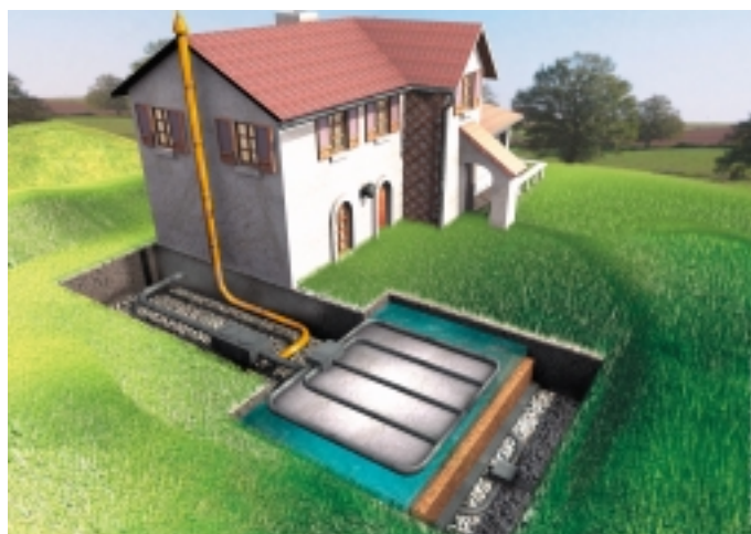
Epandage par un sable de substitution : filtre à sable vertical drainé.
