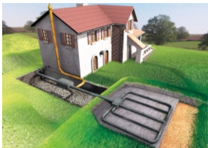
Dispositif d'épuration surélevé avec terre d'infiltration.
