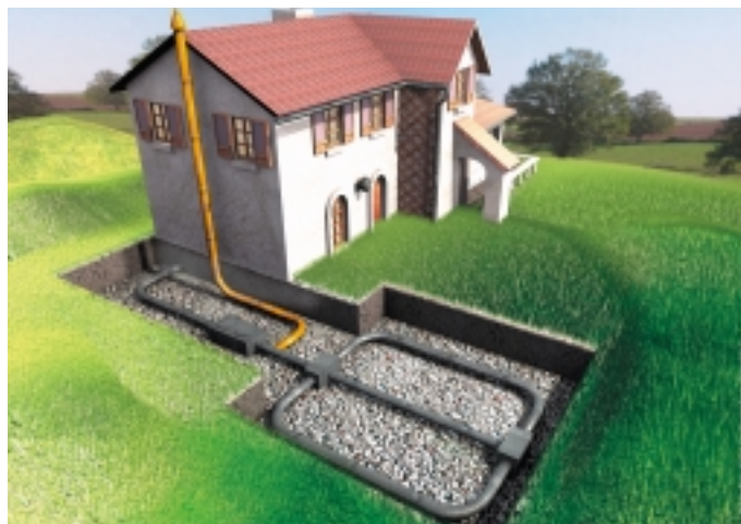
Epandage par le sol : épandage souterrain par tranchée.
